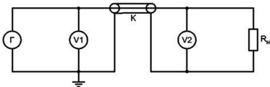
Г - генератор; V1, V2 - вольтметры; К - кабель; R<sub>н</sub> - нагрузочное сопротивление
