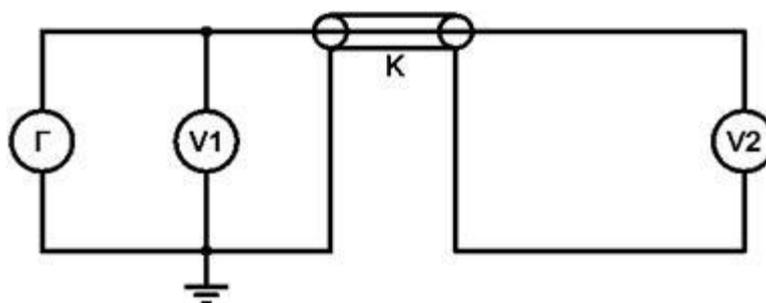
Г - генератор; V1, V2 - вольтметры; К – кабель
